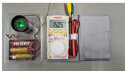
図1 製作したLED簡易比色計
