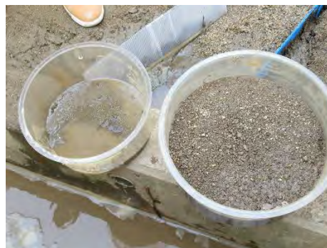
図4. 水量による堆積した土砂の違い (写真左：治水対策あり 写真右：治水対策なし)
